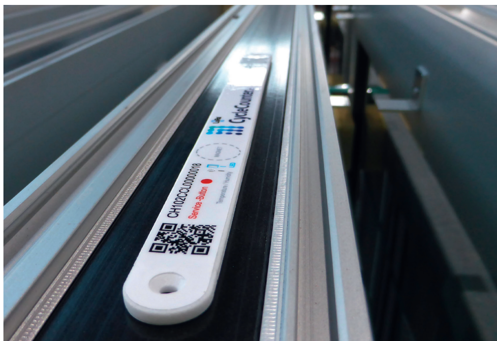
Le capteur CycleCounter® monté correctement sur le cadre de la fenêtre ou de la porte.
