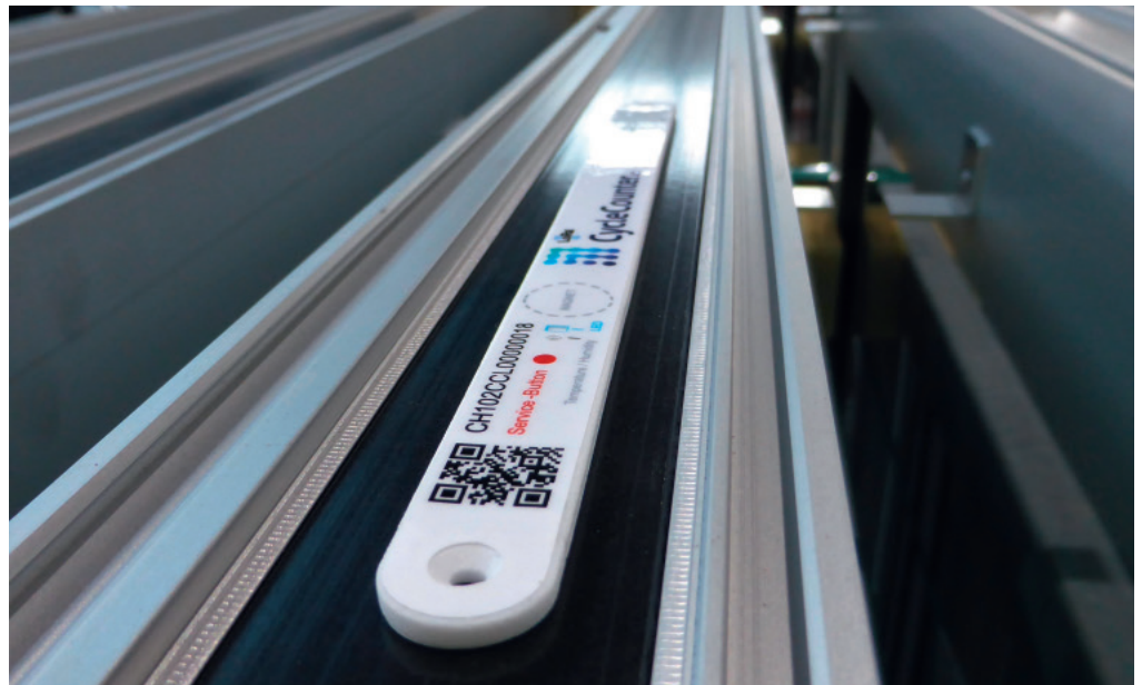
Der korrekt montierte Cycle Counter®-Sensor am Fenster- oder Türrahmen.
